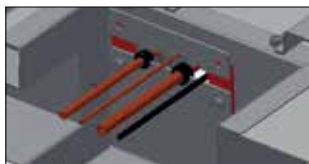
Rys. 9. Sposób wyprowadzenia i uszczelnienia przewodu kapilary, przewodu iskrownika, rurki palnika głównego i rurki palnika kontrolnego
