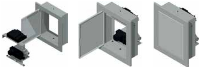
Rys. 6. Montaż sterownika gazu wraz z odbiornikiem w skrzynce rozdzielczej
