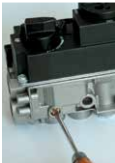
Rys. 13. Sposób regulacji minimalnej wysokości płomienia palnika głównego
