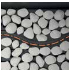
Rys. 18. Poprawne rozmieszczenie elementów dekoracyjnych - kamienie
