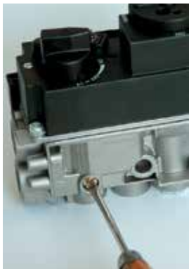
Рис.13. Способ регулировки минимальной высоты пламени главной горелки
