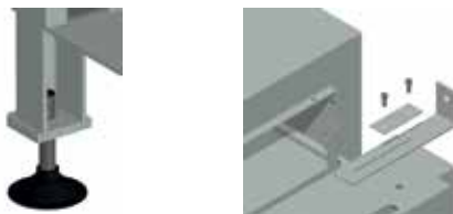
Rys. 3. Stopka poziomująca oraz regulowany uchwyt mocujący
