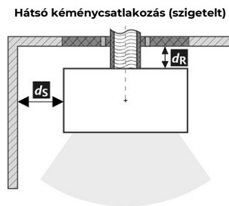
A füstcső áthaladása éghető anyagból készült falon
