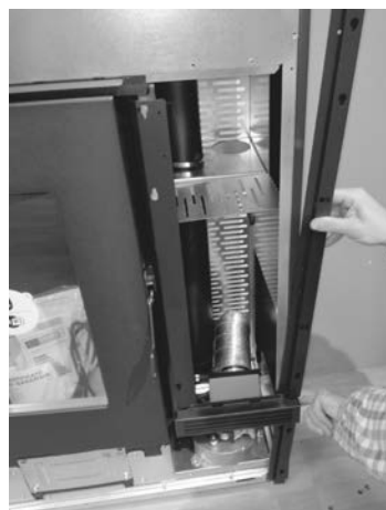
. 54 - Podnoszenie odpowietrznikaRys. 55 - Wstawianie pionu
