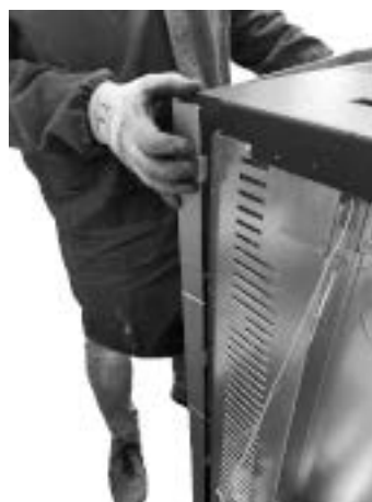
. 27 - Odkręć śruby Rys. 28 - Zwolnij panel boczny
