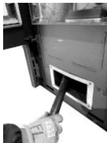
. 115 - Czyszczenie za pomocą środka do czyszczenia rur Rys. 116 - Odkurzanie popiołu
