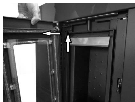
. 19 - Odkręcanie śrubRys. 20 - Demontaż drzwiczek
