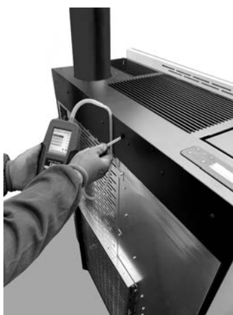
Rys. 110 - Podłączenie cyfrowego przełącznika ciśnienia (Mithos 3 Plus12/14)
