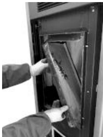
. 122 - Zdjęcie ścian bocznych
