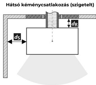
A füstcső áthaladása éghető anyagból készült falon
