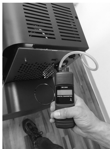
Fig. 48 - Podłączenie presostatu cyfrowego
