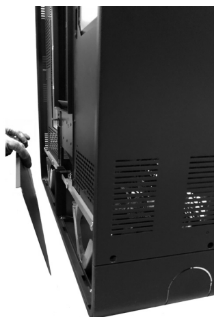
Fig. 37 - Odczepianie profilu dolnego
