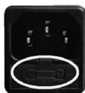
Fig. 47 - Drzwiczki z bezpiecznikami do wyjęcia
