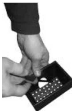
. 33 - Wyciąganie paleniska Rys. 34 - Czyszczenie paleniska
