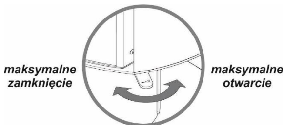
Rysunek 12. Ustawienie przycisku regulacji dopływu powietrza w pozycji maksymalnego otwarcia dla ogrzewacza CERES TOP
